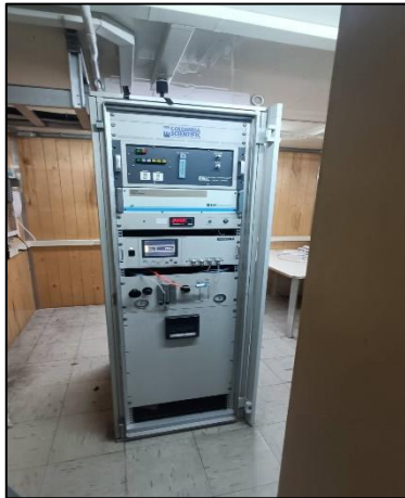
รูปที่ 2-3 ระบบตรวจสอบคุณภาพอากาศแบบต่อเนื่อง (CEMs)
